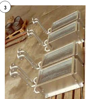
3 Procesluft LUFO i ribberørdførelse luft/hedt olie.
